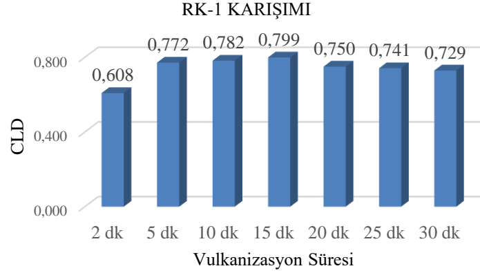
Şekil 3. RK-1 Karışımına Ait Farklı Vulkanizasyon Sürelerindeki Çapraz Bağ Yoğunlukları
